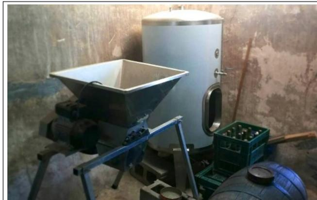
Actualmente, la elaboración casera de la sidra se ha vuelto mucho más asequible por la aparición de un variado instrumental de precios y proporciones moderadas. En la imagen, picadora, prensa, barricas, botellas y caja
